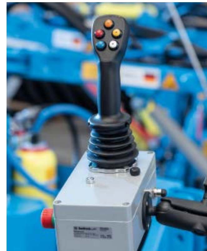
Das Reinigungssystem wird bequem per Joystick vom Fahrzeug aus gesteuert und reinigt die Module im Vorbeifahren.
