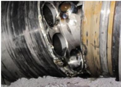
Defekte Axialkolbenpumpe durch
