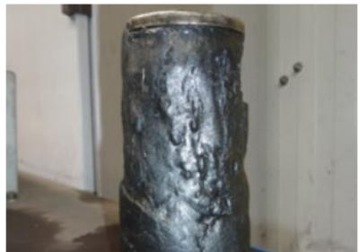
Kontaminierter Systemfilter durch abgelöste
