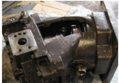
Defekter Hydromotor durch Luft im System
