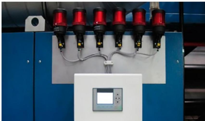
Steuerung von Wassersensoren an einer Kunststoffspritzgussmaschine
